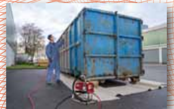
Applicazione di smalto a solvente su Lamiera con ugello Fine Finish.
