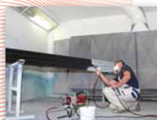
Applicazione di smalto poliuretano su Lamiera con ugello Fine Finish.
